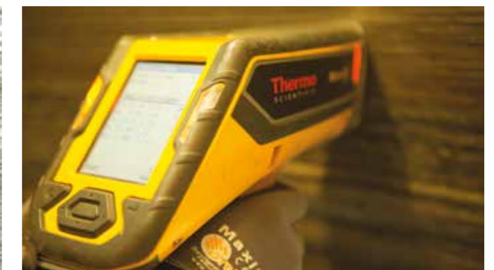
PMI/FN-Inspektion unter Einsatz des XRF-Verfahrens
