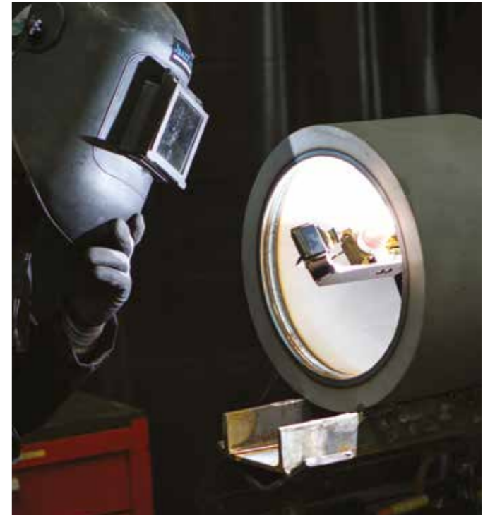
AZZ WSI bietet eine einzigartige, voll automatisierte Reparaturlösung für Stützdurchmesser zwischen 5 cm (2") und 60 cm (24").
