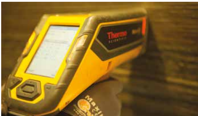
Inspección PMI/FN mediante XRF
