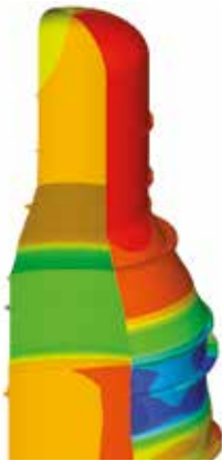
Gráfico sombreado de la contracción diametral prevista de la columna de vacío
