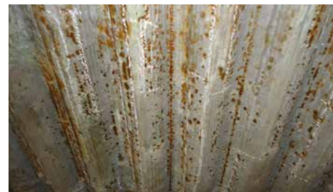
Rohrwand nach Kupfersulfatetest
