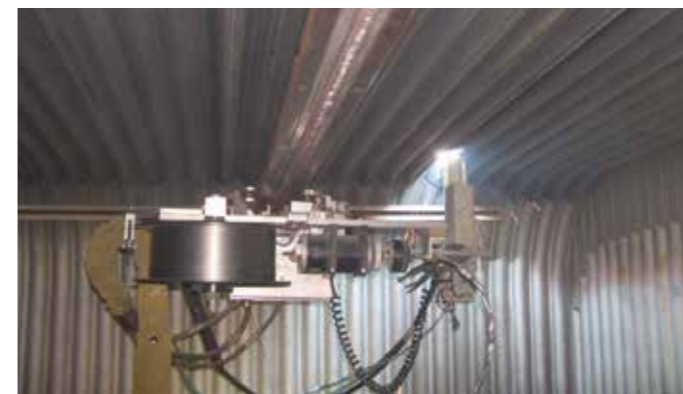
Wenn der Schaden großflächig ist, sollte die Unifuse Auftragsschweißung automatisch durchgeführt werden, um die erforderliche Dicke der Auftragschweißschicht wieder herzustellen.
