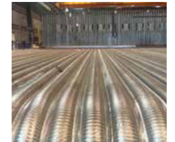
Gebogene Membranwand mit plattierten Rohren
