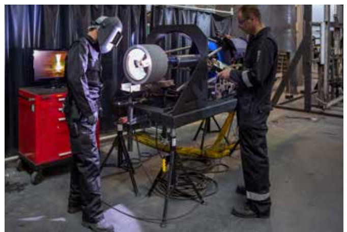
Rechargement d'un piquage avec Nozzlefuse 624
