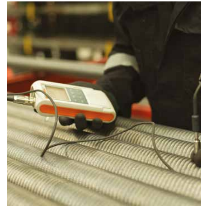
Medição de espessura
