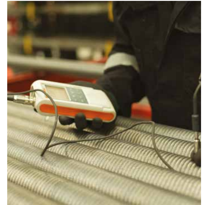
Control de espesores
