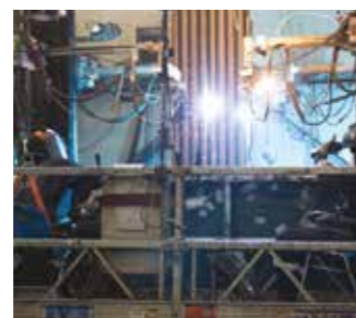
Rechargement par soudage à 360° de panneaux
