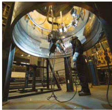
Maquette d'un rechargement par soudage automatisé
