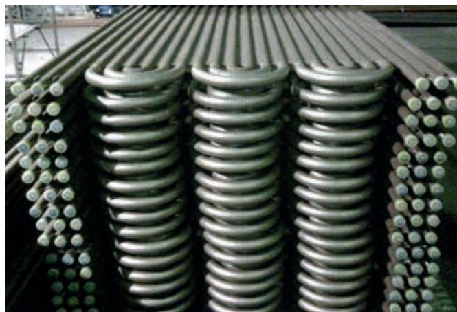
Serpentín de sobrecalentador
