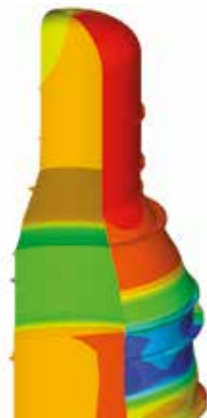
Gráfico sombreado de la contracción diametral prevista de la columna de vacío
