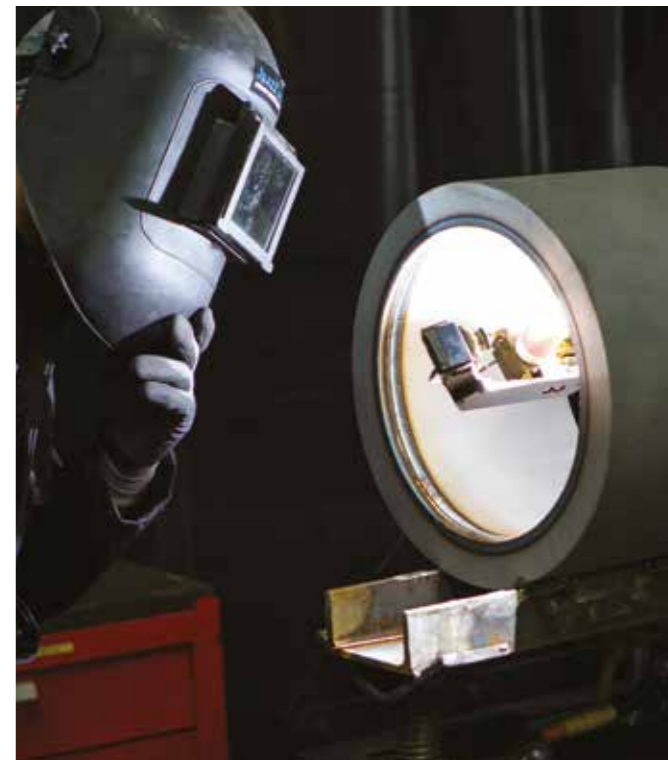
AZZ WSI ofrece una solución de reparación totalmente automatizada para un diámetro de interior desde 2" hasta boquillas y bocas de hombre de 24"
