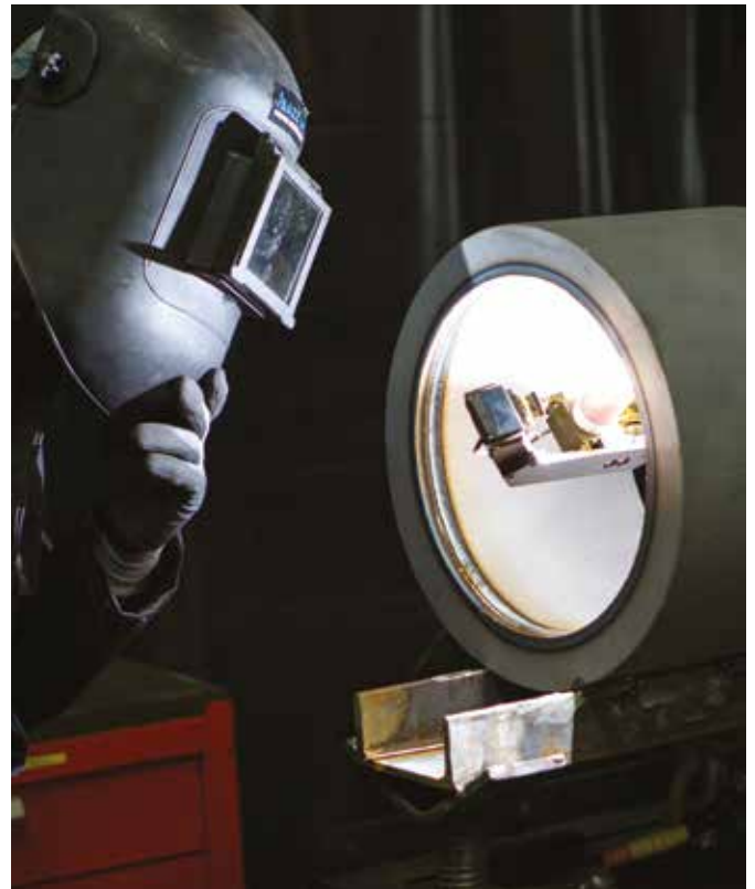
AZZWSI offre une solution unique de réparation sur site entièrement automatisée pour le diamètre intérieur de piquage allant de 50 à 610mm
