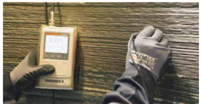
Mesure de l'épaisseur
