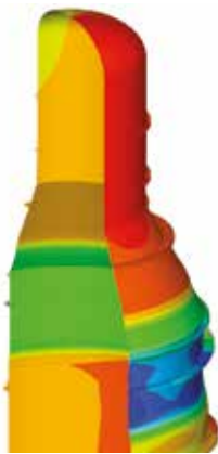
Diagramme des retraits diamétral prévu pour le rechargement d'une virole
