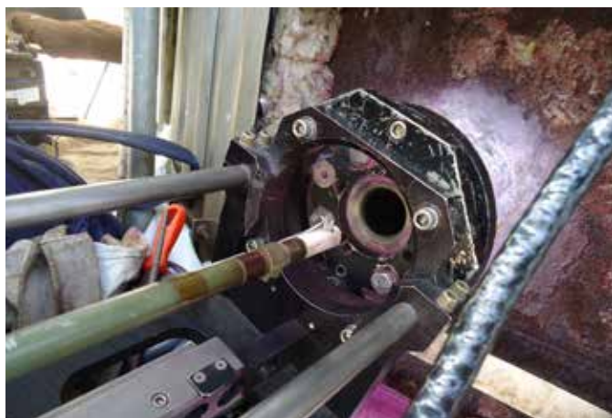
Riparazione automatizzata di un ugello direttamente sul campo
