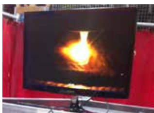
Nozzlefuse 624: videocamera incorporata per un controllo visivo in tempo reale del riporto
