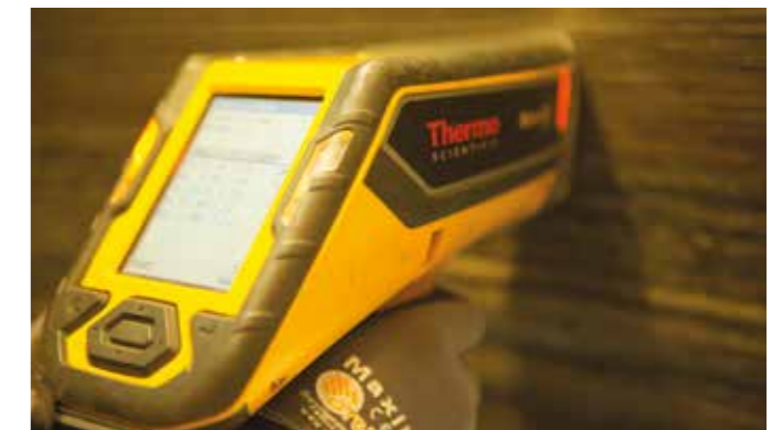
PMI/FN-Inspektion unter Einsatz des XRF-Verfahrens
