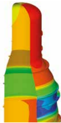
Der schattierte Bereich der Vakuumsäule zeigt die vorausberechnete Schweißschrumpfung des Durchmessers an
