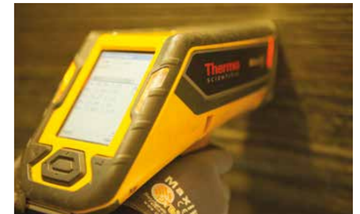
Inspección PMI/FN mediante XRF
