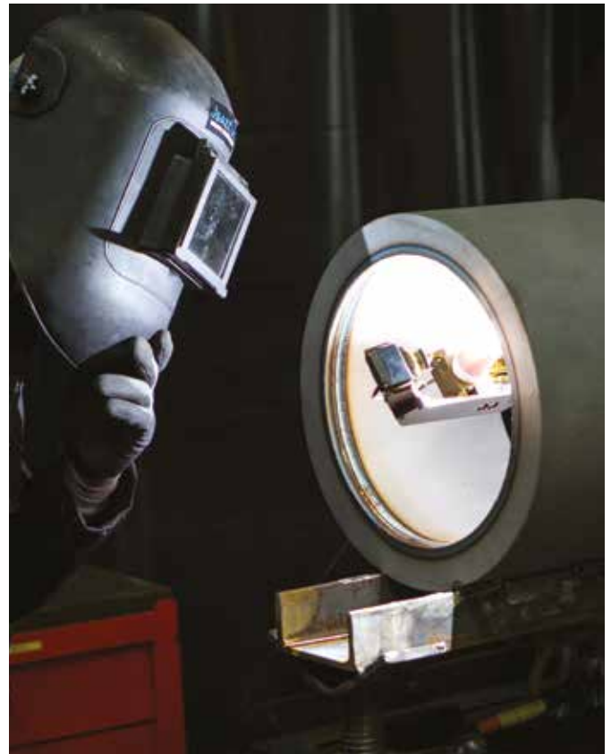
A AZZWSI oferece uma solução de reparo exclusiva e totalmente automatizada para diâmetros internos de bocais de 2 polegadas a 24 polegadas
