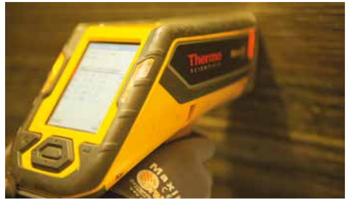
Inspeção PMI/Ferrite Number com o uso de fluorescência RX (XRF)
