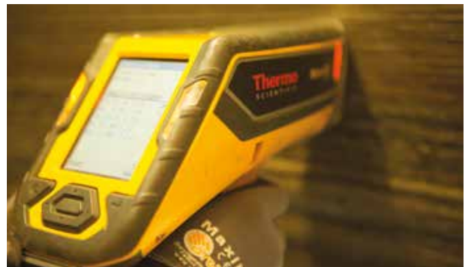
Ispezione PMI/FN mediante XRF
