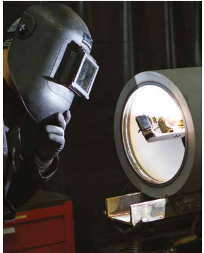
AZZWSI offre una soluzione completamente automatica per il rivestimento e la riparazione interna degli ugelli in una gamma che va dai 2 ai 24 pollici
