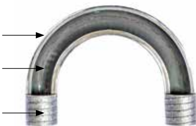
Querschnitt eines gebogenen Rohres
